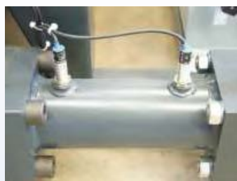
Verschleißfreie elektronische Sensoren
