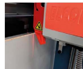
Schaltereinheit direkt am Sägeaggregat
