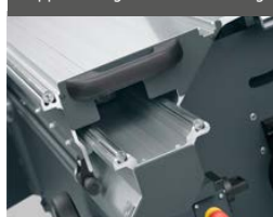
Doppelrollwagen mit Stahlführung.
