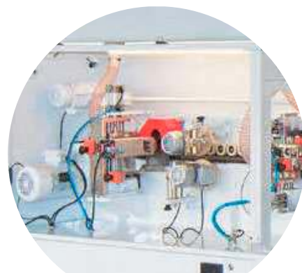
Notaggregat, ausgestattet mit 2,2 kW HF-Motor
