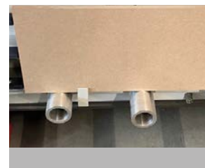
Schnittlinienlaser für horizontale und vertikale Sägeschnitte
