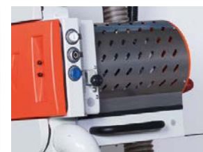
Schaltereinheit direkt am Sägeaggregat
