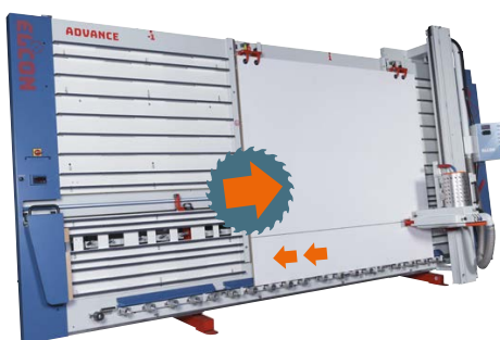
ELCON Vorritz- und Nutsystem mit Sägeblatttiefeinstellung
