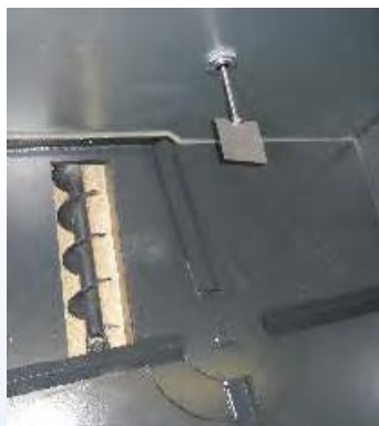
Rührwerk, Förderschneckenverdichter und Füllstandsmelder im Inneren
