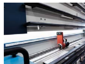
Schwerer Längsanschlag mit Feineinstellung, beleuchteter Skala
