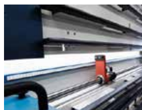
Schwerer Längsanschlag mit Feineinstellung, beleuchteter Skala
