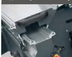
Doppelrollwagen mit Stahlführung.
