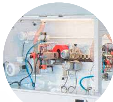
Nutaggregat, ausgestattet mit 2,2 kW HF-Motor
