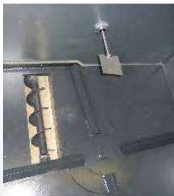
Rührwerk, Förderschneckenverdichter und Füllstandsmelder im Inneren
