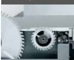
Vorritzer – separater Vorritzermotor
