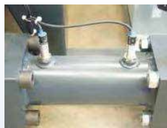
Verschleißfreie elektronische Sensoren
