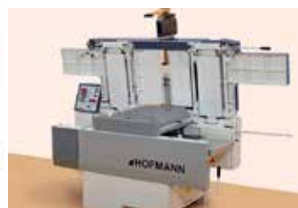
beide Abrichttische werden gemeinsam aufgeklappt – Schutzhaube aufsetzen – fertig
