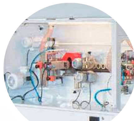
Nutaggregat, ausgestattet mit 2,2 kW HF-Motor
