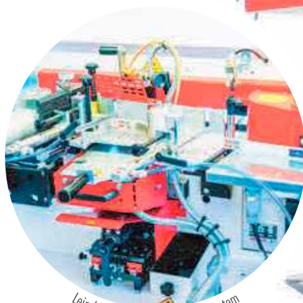
Leimbecken mit Schnellwechselsystem
