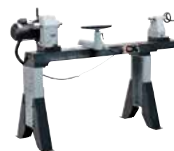
mit Tiefbett als Außendrehvorrichtung
