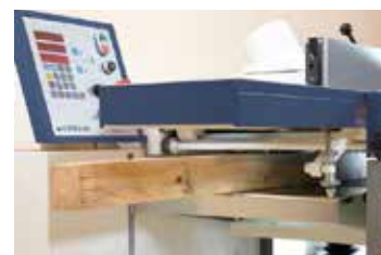
Dickenhobeln bei geschlossenem Tisch – ohne Umklappen – sogar gleichzeitiges Abrichten ist möglich – dadurch optimale Messerausnutzung
