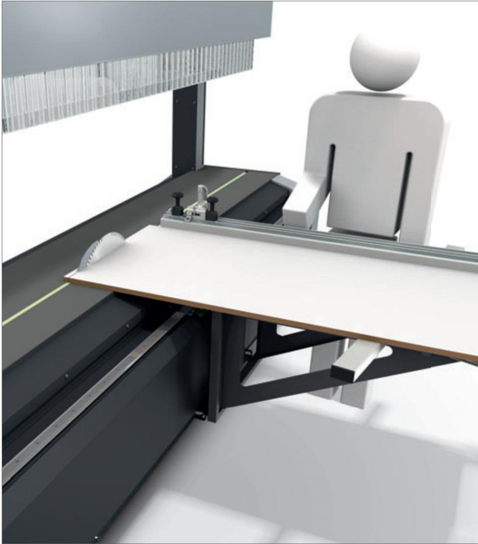
\_ Formatieren mit fixiertem Sägeaggregat
