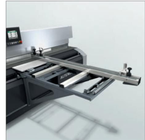
– Die Altendorf 2e ist für Betriebe geeignet, die Plattenmaterialien möglichst flexibel und komfortabel schneiden wollen. Die Altendorf 2e kombiniert die Flexibilität einer herkömmlichen Formatkreissäge mit den Vorteilen einer Plattensäge. Das Sägeaggregat verfügt über einen 3-kW-Motor mit einer Spitzenleistung von bis zu 6 kW. Das Hauptsägeaggregat ist stufenlos regelbar (1500–5 000 U/min). Bei dem Sägeblattüberstand von 70 mm ist auch die Bearbeitung von Massivholz möglich.
