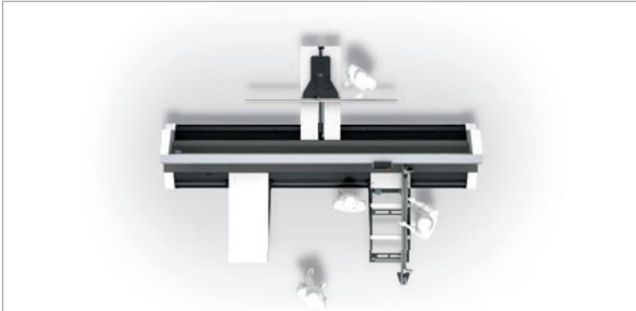
– **Arbeitspositionen:** Die Altendorf 2e ist beidseitig bedienbar. Das Führungssystem zum Anbringen der Tische und von Zubehör sowie das Touchpanel befinden sich ausschließlich auf der Vorderseite der Maschine. Auf der Rückseite befinden sich Ansatzpunkte zur Fixierung von zusätzlichen Auflagetischen und Zubehör.
