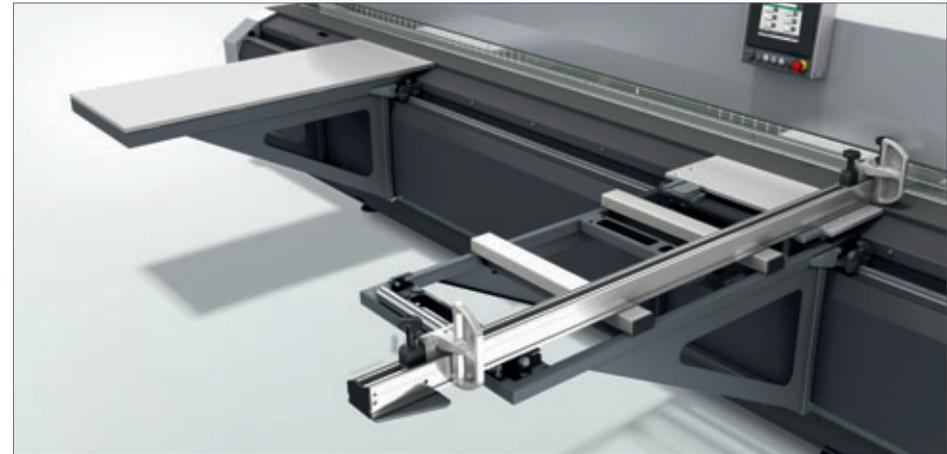
– **Auflagetische:** Um die Werkstücke aufzulegen und zur Aufnahme von Zubehör stehen mehrere Auflagetische in verschiedenen Formaten zur Verfügung. Sie können diese Auflagetische auf der Vorderseite der Maschine frei am Führungssystem anbringen und zur Positionierung entlang der Tischplatte verschieben. Auf der Rückseite stehen Ihnen feste Anbaupunkte zur Aufnahme von Auflagetischen und/oder des Parallelanschlags zur Verfügung.
