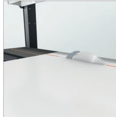
– **LASER:** Bei abgesenktem Sägeblatt bleibt die Schnittfuge durch den Laserstrahl deutlich erkennbar. Damit wird das Anlegen und Anschneiden von unformatierten Materialien erleichtert.
