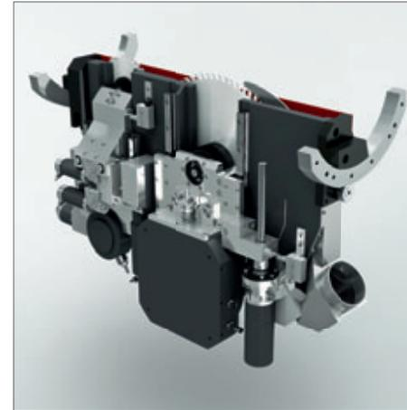
– **Sägeaggregat:** Das neue Sägeaggregat der Altendorf 2 ist beidseitig bis 46° schwenkbar. Die Drehzahlen lassen sich stufenlos von 1500–5000 U/min einstellen. Nennleistung: 5 kW, Spitzenleistung: 11 kW.
