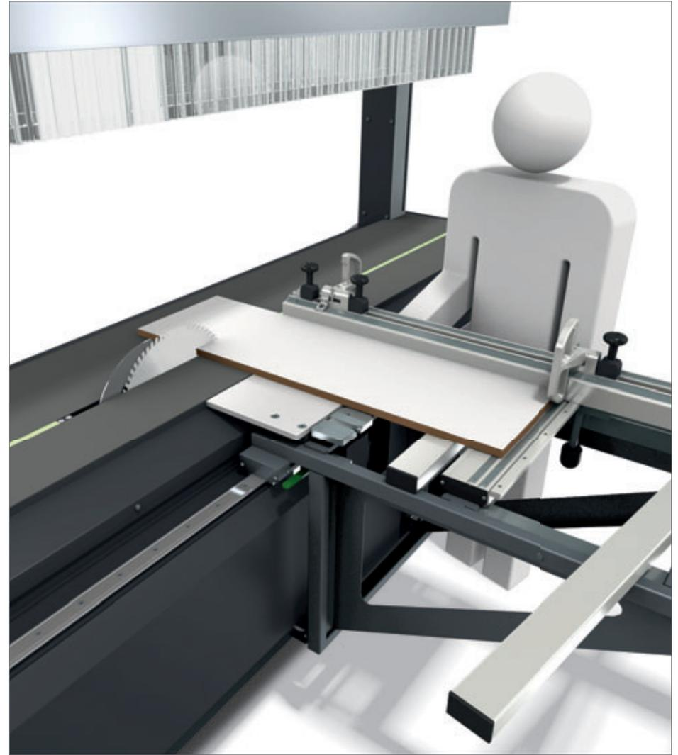
\_ Ablängen kurzer, schmaler Streifen mit fixiertem Sägeaggregat
