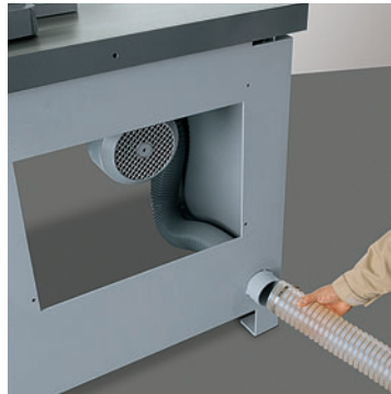
Absaugstutzen am Maschinenständer (Absaugstutzen: Ø 100 mm).
