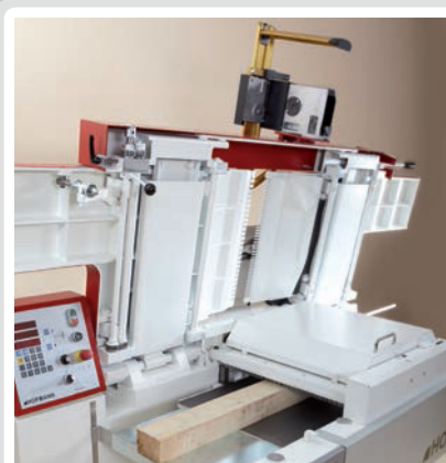
Die Abrichttische sind beim Standardmodell aufklappbar.
