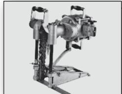
**1926** Maschine Type A – die erste tragbare Zimmereimaschine der Welt
