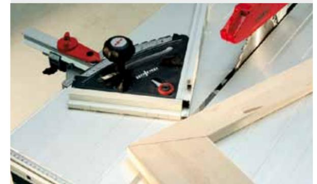
... oder Verstellung des Anschlages. Ergebnis: perfekte 90°-Verbindungen.
