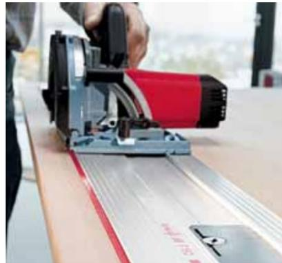
Zwei steckbare Haftstränge an der Schienenunterseite bewirken eine absolut rutschsichere und materialschonende Auflage.
