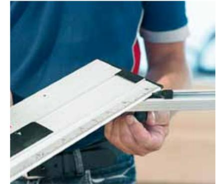
Die für den Winkelanschlag benötigte Gradzahl wird einfach über die große und gut lesbare Skala eingestellt und über die Arretierung fixiert.
