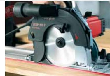
Eintauchen, Sägen - fertig! Der Spaltkeil schnappt dabei selbstständig in den Sägeschnitt.
