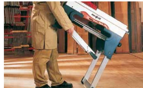
Die ERIKA 70 Ec können Sie alleine auf- und abbauen. Sekundenschnell und ohne Werkzeug können Sie die integrierte Stationär-Einrichtung ausklappen.
