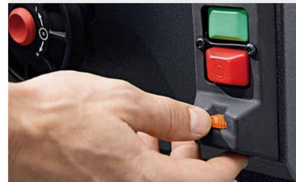
Der Ein- und Ausschalter sowie die Einstellung der Drehzahl liegen rechts an der Frontplatte. Sie bedienen die Maschine ausschließlich mit der rechten Hand. Die linke bleibt am Werkstück.
