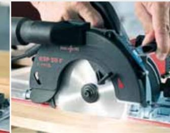
Schrägschnitte bis 45° auf der Führungsschiene: Kein Problem für die KSP 55 F!
