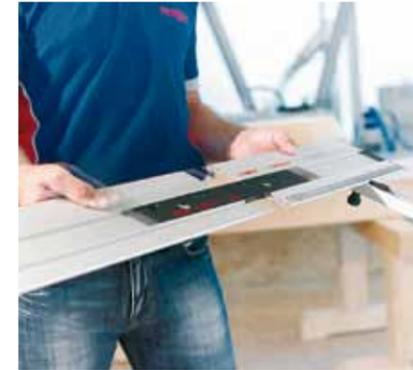
Die Einheit mit Winkelanschlag und Führungsschiene wird am Werkstück angelegt.
