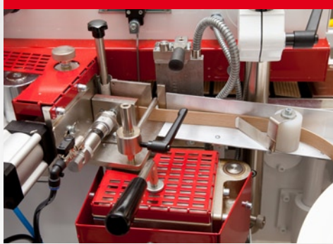
Direktleimangabe an das Werkstück: Teflonbeschichtetes Leimbecken mit 2 kg Fassungsvermögen, auslaufsicher mit Leimvorrat von unten (Überschüssiger Leim wird automatisch dem Leimbecken wieder zugeführt), fein dosierbarer Leimauftrag mittels Leimrolle, elektronische Temperaturkontrolle mit automatischer Stand-by-Funktion (Verhindert das der Leim verbrennt, wenn die Maschine längere Zeit nicht benutzt wird aber dennoch eingeschaltet ist)
