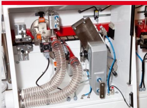
Hochfrequenz-Kappsäge ausgestattet mit HF-Motor 0,20 kW, 12.000 U/min., 2 Sägeblätter und hochpräzisen Linearführungen sorgen für einen sauberen und präzisen Sägeschnitt
