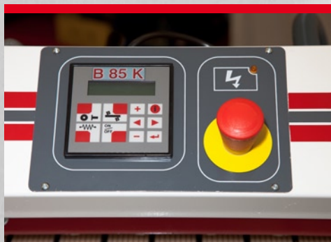
PLC-Display mit LCD-Anzeige und Tastenfeld steuert die Leimtemperatur-Einstellungen, die automatische Temperaturreduktion bei Nichtbenutzung der Maschine, An + Ausschalten von Aggregaten und Fehlerdiagnostik
