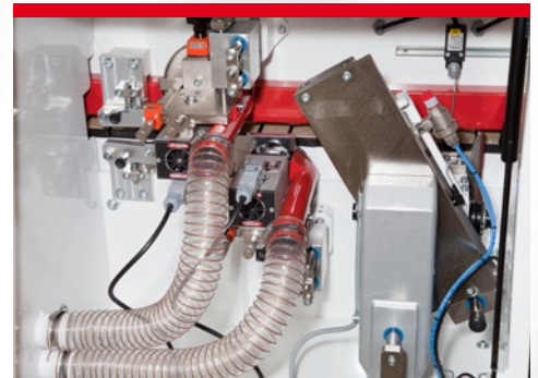
Hochfrequenz Kombi-Frässtation, 2 leistungsstarke 0,27 kW Hochfrequenz-Motoren mit HM-WPL Spezialfräsern, geeignet für Radius- und Fasenfräsen, horizontale und vertikale Abtastung des Werkstückes, Aggregatverstellung ausgestattet mit Digitalzählern zur Einstellung auf unterschiedliche Kantenarten, 2 Späneabsaughauben mit zentralem Absaugstutzen Ø 120mm, Höhenverstellung des oberen Aggregates mit dem Oberdruck
