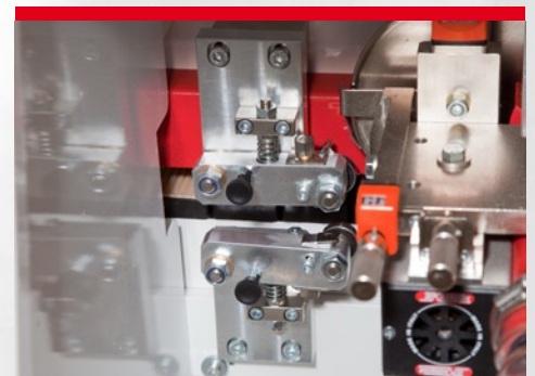
Flächenziehklagenaggregat: Befreit mit leicht ziehendem Schnitt die Werkstückfläche von etwaigen Kleberesten an der Leimfuge
