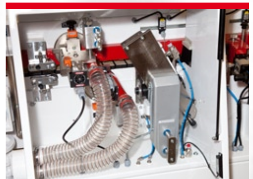
Hochfrequenz-Kappsäge ausgestattet mit HF-Motor 0,20 kW, 12.000 U/min., 2 Sägeblätter und hochpräzisen Linearführungen sorgen für einen sauberen und präzisen Sägeschnitt
