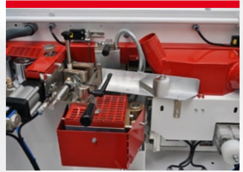
Direktleimangabe an das Werkstück: Teflonbeschichtetes Leimbecken mit 2 kg Fassungsvermögen, auslaufsicher mit Leimvorrat von unten (Überschüssiger Leim wird automatisch dem Leimbecken wieder zugeführt), fein dosierbarer Leimauftrag mittels Leimrolle, elektronische Temperaturkontrolle mit automatischer Stand-by-Funktion (Verhindert das der Leim verbrennt, wenn die Maschine längere Zeit nicht benutzt wird aber dennoch eingeschaltet ist)
