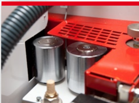
Andruckzone bestehend aus einer angetriebenen Andruckrolle im Synchronlauf mit der Leimwalze und einer einstellbaren Anpressrolle mit Federspannung für eine gute Fugenbildung des Kantenmaterials mit dem Werkstück
