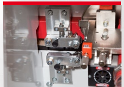
Flächenziehklängenaggregat: Befreit mit leicht ziehendem Schnitt die Werkstückfläche von etwaigen Kleberesten an der Leimfuge
