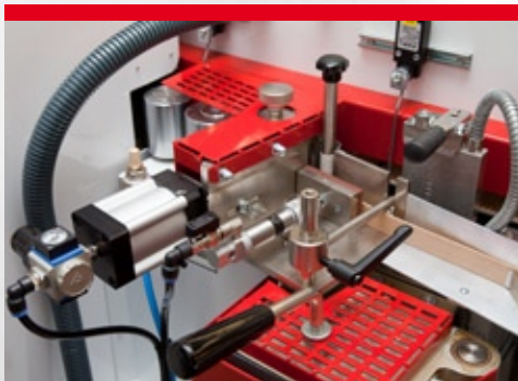
Vorkappschere für Rollenmaterial bis 2mm Kantendicke
