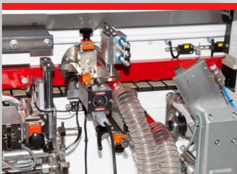
Hochfrequenz Kombi-Frässtation, 2 leistungsstarke 0,27 kW Hochfrequenz-Motoren mit HM-WPL Spezialfräsern, geeignet für Radius- und Fasenfräsen, horizontale und vertikale Abtastung des Werkstückes, Aggregatverstellung ausgestattet mit Digitalzählern zur Einstellung auf unterschiedliche Kantenarten, 2 Späneabsaughauben mit zentralem Absaugstutzen Ø 120mm, Höhenverstellung des oberen Aggregates mit dem Oberdruck
