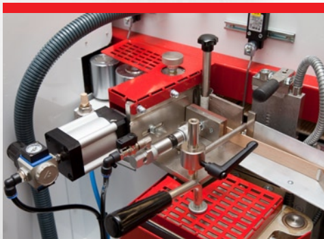
Vorkappschere für Rollenmaterial bis 2mm Kantendicke
