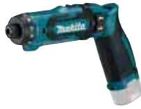
Ein kleiner und leichter 7,2 V Akku-Knickschrauber. Ein kompakter Bohrschrauber mit einer 21-fachen Drehmomenteinstellung. Stoppt, sobald das eingestellte Drehmoment erreicht ist. Das Gerät hat ein 2-Gang-Getriebe und eine 1/4" Sechskant-aufnahme.
