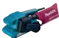
Ein leicht bedienbarer Bandschleifer mit einem 650 W Motor. Geeignet für 76 mm breite Schleifbänder. Die Bandgeschwindigkeit beträgt 270 m/min. Die Oberseitenkonstruktion erlaubt es dem Schleifer, auch als Tischwerkzeug eingesetzt zu werden. Gerät
