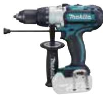
Leistungsstarker Akku-Schlagbohrschrauber mit 18 V und einem 3-Gang-Vollmetall-Planetenge triebe. Das Schlagwerk ist je nach Anwendung abschaltbar, das max. Drehmoment beträgt 80 Nm. Dieses ist in 16 Stufen plus Bohrstufe einstellbar.
