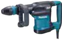
Ein leistungsfähiger Stemmhammer. Kompatibel mit SDS-MAX Einsteckwerkzeugen. Die Motorleistung von 1.100 W und Einzelschlagstärke von 8,1 J sorgen für effizienten Materialabtrag. Einstellbare Schlagzahl: 1.100-2.650 min<sup>-1</sup>. Anti-Vibrations-Technologie AVT für geringe Vibration.
