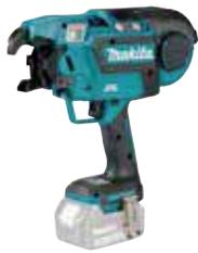
Ein benutzerfreundlicher Bewehrungsverbinder für Moniereisen und Fußbodenheizungen. Einhandbedienung erlaubt Positionierung von Moniereisen. Die Bindekraft kann je nach Material zwischen 1 und 6 Nm eingestellt werden.
