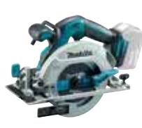
Akku-Handkreissäge ideal geeignet für Dacharbeiten und im Innenausbau. Sie ist für Sägeblätter mit 165 mm Durchmesser ausgelegt und erreicht eine max. Schnitttiefe von 57 mm. Die integrierte Blasvorrichtung hält die Schnittstelle sauber, eine leuchtstarke Doppel-LED leuchtet das Werkstück zusätzlich aus.
