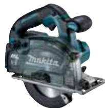
Akku-Metallhandkreissäge mit einem bürstenlosen Motor und 18 V. Die sehr handliche Maschine dient zum Trennen von Profilen und Vollmaterial aus Metall. Die transparente Staubsammelbox ist aus stoßfestem Polycarbonat gefertigt, die Grundplatte besteht aus rostfreiem Stahl.
