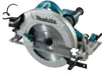
Eine effiziente und robuste, hochleistungsfähige Handkreissäge mit einem 2.000 W Motor und einer Drehzahl von 4.300 min<sup>-1</sup>, konzipiert für professionelle Anwendungen. Für Sägeblätter mit 270 mm Durchmesser erreicht die Maschine eine Schnitttiefe von max. 101 mm. Kugelgelagerter Motor gewährleistet eine lange Lebensdauer.
