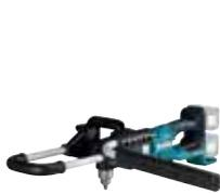
Zum einfachen und schnellen Erstellen von Löchern für beispielsweise Zaunpfähle etc. Der bürstenlose 2x18 V Motor erzielt ein Drehmoment bis zu 136 Nm. Es stehen zwei Drehzahlbereiche zur Verfügung, 0 - 1.400 für schnelle Bohrungen in sandigem Boden oder 0 - 350 für Bohrungen in schwerem Lehmboden. Mit Rückwärtslauf bei blockierendem Bohrer.
