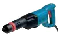
Ein Stemmhammer für leichte Meißelarbeiten. Kompatibel mit SDS-PLUS Einsteckwerkzeugen. Motorleistung 550 W, Einzelschlagstärke 1,8 J. 12-fache Meißelverstellung. Schlagzahl einstellbar zwischen 2.000 und 3.500 min<sup>-1</sup>.
