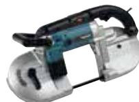
Eine leichte und kompakte Bandsäge. Sauberes und präzises Schneiden. Geeignet für den Trockenschnitt ohne Schmierung. Die maximale Schnittleistung von Rundmaterial beträgt 120 mm, Bandgeschwindigkeit kann zwischen 1 und 1,7 m/s eingestellt werden. Kann auf einen Ständer auf einer Baustelle montiert werden.
