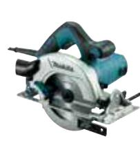
Eine robuste Handkreissäge mit Motorbremse, 1.050 W Motor und einer Drehzahl von 5.200 min<sup>-1</sup>, konzipiert für den professionellen Einsatz. Für Sägeblätter mit 165 mm Durchmesser erreicht die Maschine eine Schnitttiefe von max. 54,5 mm. Kompaktes Design für zusätzliche Kontrolle und Sicherheit. Führungsschiene und Adapter als Zubehör.
