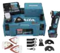
Handliches Multifunktionswerkzeug zum Sägen, Schneiden und Schleifen. Umfangreiches Zubehör für ein breites Anwendungsspektrum optional lieferbar. Mit Sanftanlauf und Wiederanlaufschutz. Die Oszillations-Zahl kann zwischen 6.000 und 20.000 min<sup>-1</sup> geregelt werden. Der Oszillationswinkel beträgt jeweils 1,6° nach rechts und links.
