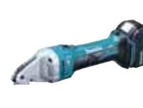
Eine Akku-Blechscherer für gerade und kurvenförmige Schnitte mit einem Schnittradius von 30 mm, schneidet einen sauberkantigen Streifen von der Mitte aus. Schnittleistung 2,5 mm für Aluminium und 1,0 mm für Stahl. Das Gerät hat eine Hubzahl von 4.300 min<sup>-1</sup>.
