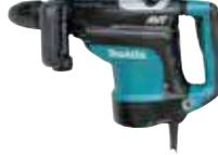
Leistungsfähiger 1.350 W Kombihämmer mit einem Anti-Vibrations-Technologie AVT für SDS-MAX Einsteckwerkzeuge. Mit zusätzlicher Vibrationsdämpfung im Handgriff. Bohrleistung in Mauerwerk: 45 mm, Einzelschlagstärke 9,4 J. Mit seinen Bohr- und Meißelleistungen ist dieses Gerät eine ideale Wahl für Renovierungs- und Bauarbeiten.
