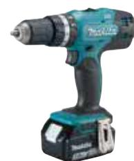
Leistungsstarker Akku-Schlagbohrschrauber mit 18 V und einer elektronisch regelbaren Drehzahl. Das Schlagwerk ist je nach Anwendung abschaltbar, das max. Drehmoment beträgt 42 Nm. Dieses ist in 16 Stufen plus Bohrstufe einstellbar.
