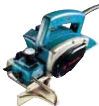
Ein kompakter 600 W Hobel mit einer Hobeltiefe von 1 mm und einer Hobelbreite von 82 mm. Eine hohe Hobelwellendrehzahl ermöglicht einwandfreies Finish. Geräuscharmer Betrieb und einfache Einstellung der Spanabnahme durch Drehknopf. Inklusive Parallelanschlag. Kommt in einem MAKPAC.
