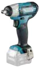
Kompakter und leistungsstarker 12 V max. Akku-Schlagschrauber mit einer sehr kurzen Bauform. In Kombination mit dem Aluminium-Druckguss Gehäuse ist er sehr robust und leicht bedienbar. Mit 1/2" Werkzeugaufnahme und 145 Nm Anzugsmoment. Eine leuchtstarke LED sorgt für gute Sicht.
