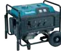
Zuverlässiger und langlebiger Generator mit Hochleistungs-OVH-Motor für max. 2.400 W Elektrowerkzeuge. Der Generator ist mit einem Strom- und Spannungsmessgerät ausgestattet und einfach zu starten. Durch einen Ölstandssensor schaltet das Gerät bei zu niedrigem Ölspiegel automatisch ab. Der Generator hat einen Kraftstofftank mit 25 l Fassungsvermögen.
