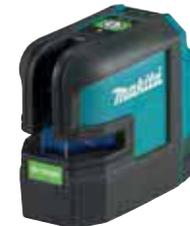
Selbstnivellierender Kreuzlinienlaser mit grünen vertikalen und horizontalen Linien, die getrennt oder zusammen verwendet werden können. Sichtweite 35 Meter. 2 Helligkeitsstufen. Der Laser ist staub- und spritzwassergeschützt mit IP54-Schutzklasse, seine Laufzeit mit einer 4,0 Ah-Akkuladung beträgt etwa 20 h.
