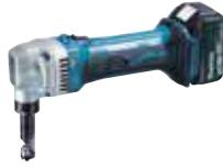
Der Akku-Knabber mit schlanker Bauform eignet sich ideal zum Trennen von Blechtafeln, Well- und Trapezblechen. Die Knabbermatrize ist um 360° stufenlos verstellbar. Gerade und Kurvenschnitte lassen sich präzise ausführen. Die Schnittleistung beträgt 2,5 mm für Aluminium und 1,6 mm für Stahl.
