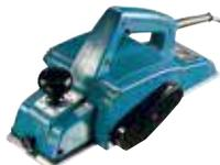
Ein starker 840 W Breithobel für härteste Beanspruchung. Mit großer V-Nut für leichtes Anfasen. Spanabnahme von 0 bis 2 mm stufenlos einstellbar, Hobelbreite 110 mm. Geräuscharmer Betrieb und einfache Einstellung der Spanabnahme mittels Einstellknopf.
