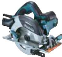
Eine robuste Handkreissäge mit Motorbremse, 1.100 W Motor und einer Drehzahl von 5.500 min<sup>-1</sup>, konzipiert für den professionellen Einsatz. Für Sägeblätter mit 165 mm Durchmesser erreicht die Maschine eine Schnitttiefe von max. 54,5 mm. Kompaktes Design für zusätzliche Kontrolle und Sicherheit. Führungsschiene und Adapter als Zubehör.
