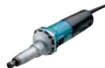
Ein Geradschleifer mit einer 6 mm Spannhülse. Ausgestattet mit Konstantelektronik und SJS-Technik, um den Benutzer vor dem Rückschlag zu schützen. Geeignet für kleinmaßstäbiges Schleifen einschließlich des Abgratens, wobei das lange Spindelgehäuse eine flexible Handhabung ermöglicht. Drehzahl kann zwischen 1.800 und 7.000 min<sup>-1</sup> eingestellt werden.
