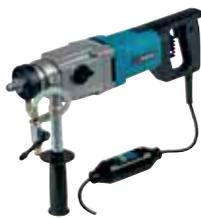
Diese Diamantbohrmaschine kommt mit einem starken 1.700 W Motor beispielsweise für die Nutzung bei Arbeiten an Elektroinstallationen und Sanitäranlagen. Mit Konstantelektronik und elektronisch regelbarer Drehzahl. Leerlaufdrehzahl: 0 bis 1.570 U/min, max. Diamant-Nass-Bohrkrone: 130 mm. Ausgeliefert mit Seitengriff und Transportkoffer.
