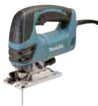
Eine leistungsfähige 720 W Pendelhubstichsäge mit dreistufiger PendelhubEinstellung + Neutralstellung. Werkzeugloser Messerwechsel für professionelle Anwendung. Wirkungsvolles Antivibrationsystem und niedriger Geräuschpegel. Motordrehzahl kann zwischen 800 und 2.800 min<sup>-1</sup> eingestellt werden. Hubhöhe 26 mm. Schnittleistung Holz 135 mm, Stahl 10 mm.
