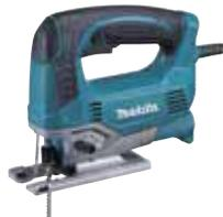
Eine 650 W Pendelhubstichsäge mit dreistufiger Pendelbewegung plus Neutralstellung. Werkzeugloser Sägeblattwechsel. Besonders Vibrationsarm für lange Arbeiten. Niedriger Geräuschpegel. Elektronisch regelbare Drehzahl von 500 bis 3.100 min<sup>-1</sup>. Hubhöhe 23 mm, hat eine max. Schnittleistung von 90 mm in Holz und 10 mm in Stahl. Kommt in einem MAKPAC.
