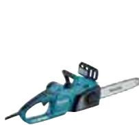
Eine kraftvolle 1.800 W Kettensäge mit schlanker Bauform. Ausgestattet mit Sanftanlauf. Sie ist ideal für den Gebrauch im Heim- und Gartenbereich. Sägeschiene 40 cm, Kettengeschwindigkeit 14,5 m/s. Ausgestattet mit einer verstellbaren automatischen Ölpumpe und werkzeugloser Kettenspannung sowie Ketten- und Schienenwechsel.
