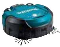
Ein Akku-Saugroboter, ideal für die Reinigung von Flächen zwischen 300 und 500m². Timerfunktion, Arbeitsbereich kann definiert werden. Sensoren schützen das Gerät vor dem Hinfallen. Abnehmbarer und waschbarer 2,5-Liter-Staubbehälter und waschbarer Filter. Inklusive Fernbedienung.
