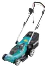
Ein leiser, leicht bedienbarer elektrischer Rasenmäher mit einem stabilen und witterungsbeständigen Polypropylen-Gehäuse. Der Rasenmäher ist ideal für Rasenflächen bis 400 m<sup>2</sup> geeignet. Er hat einen 1.200 W Motor, eine Schnittbreite von 33 cm und einen handlichen 30 l Grasfangkorb. Zentrale Schnitthöhenverstellung.
