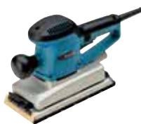
Ein geräuscharmer und leistungsfähiger vibrationsarmer Schwingschleifer für eine Vielzahl an professionellen Schleifanwendungen. Gut konzipierte Bauform für einfache Handhabung. Das Gerät hat einen starken 330 W Motor und eine Schleifplattengröße von 115 x 280 mm. Motordrehzahl 10.000 min<sup>-1</sup>.
