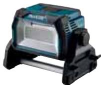
Die Leuchtstärke ist in drei Stufen einstellbar von 2.000 über 4.000 bis zu 10.000 Lumen. Die Lichtabdeckung beträgt 10 m nach vorne und jeweils 10 m zu beiden Seiten. Mit zwei Akku-Steckplätzen zur Verdoppelung der Leuchtdauer. Der Strahler ist auch mit Netzkabel zu betreiben. Der Korpus ist von -30° bis 210° vertikal verstellbar.
