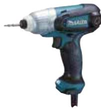
Kompakter und leichter 230 W Schlagschrauber mit 1/4"-Innensechskantaufnahme. Ein kleines und leichtes Gerät, das leicht bedienbar ist und dennoch ein hohes Anzugsdrehmoment von bis zu 100 Nm bietet. Eine leuchtstarke LED sorgt für optimale Beleuchtung.
