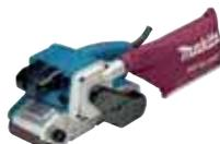
Ein leicht bedienbarer Bandschleifer mit einem starken 1.010 W Motor. Geeignet für 76 mm breite Schleifbänder. Die Bandgeschwindigkeit kann zwischen 220 und 440 m/min eingestellt werden. Die Oberseitenkonstruktion erlaubt es dem Schleifer auch als Tischwerkzeug eingesetzt zu werden.
