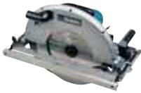
Große Handkreissäge mit einem 2.200 W Motor und einer Drehzahl von 2.700 min<sup>-1</sup>. Mit einem Sägeblattdurchmesser von 355 mm erreicht die Maschine eine Schnitttiefe von max. 130 mm. Sanftanlauf für zusätzliche Sicherheit. Die vollkugelgelagerte Struktur sowie der Motor der Maschine gewährleisten eine lange Lebensdauer.
