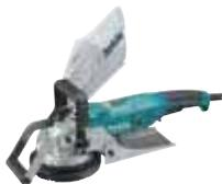
Ein Betonschleifer mit einem 125 mm Schleifscheibendurchmesser für effizientes und staubfreies Schleifen von Beton. Sein kraftvoller 1.400 W Motor liefert eine Drehzahl von 10.000 min<sup>-1</sup>. Effektive Staubabsaugung durch geschlossene Schutzhaube, Haube abnehmbar für randnahe Arbeiten.
