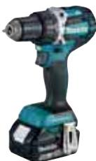
Kompakter 18 V Akku-Bohrschrauber mit einer Gehäuselänge von nur 172 mm. Das Drehmoment ist in 21 Stufen einstellbar. Der bürstenlose Motor ermöglicht die kompakte Bauform und sorgt für effizienteren Umgang mit der Energie.
