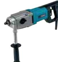
Diese Diamantbohrmaschine kommt mit einem starken 1.700 W Motor beispielsweise für die Nutzung bei Arbeiten an Elektroinstallationen und Sanitäranlagen. Mit Konstantelektronik und elektronisch regelbarer Drehzahl. Leerlaufdrehzahl: 0 bis 2.000 min<sup>-1</sup>, max. Diamant-Trocken-Bohrkrone: 130 mm. Ausgeliefert mit Seitengriff und Tragekoffer.
