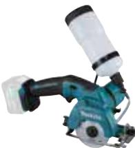
Kompakter und leichter Akku-Glas- und Fliesenschneider mit einer Drehzahl von 1.600 min<sup>-1</sup> für staubfreies Schneiden von Fliesen, Glas und anderen Hartstoffen. Ausgestattet mit einem 0,5 Liter Wassertank und 85 mm Diamantscheibe, mit einer Schnitttiefe von 25,5 mm.
