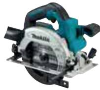
Akku-Handkreissäge mit einer sehr kompakten und kurzen Bauform. Sie ist für Sägeblätter mit 165 mm Durchmesser ausgelegt und erreicht eine max. Schnitttiefe von 57 mm. Die integrierte Blasvorrichtung hält die Schnittstelle sauber, eine leuchtstarke Doppel-LED leuchtet das Werkstück zusätzlich aus.
