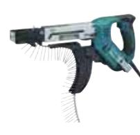
Magazinschrauber für gurtmagazinierte Schrauben mit einer Drehzahl von 3.000 min<sup>-1</sup> und einer robusten Aluminium-Zuführung für 45 bis 75 mm Schrauben. Eine präzise Schraubeneinführung gewährleistet Genauigkeit und verhindert eine schräge Verschraubung. Die gummierte Aufsetzfläche verhindert das Abrutschen von glatten Oberflächen.
