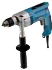
Kompakte 750 W Bohrmaschine mit niedriger Drehzahl. Das Gerät hat eine variable Drehzahl zwischen 0 und 600 min<sup>-1</sup> und ist ideal zum Bohren großer Durchmesser, z. B. im Blockhausbau. Mit Schnellspannbohrfutter mit einer Spannweite von 1,5 - 13 mm.
