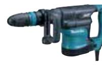
Ein leistungsfähiger Stemmhammer für intensive Anwendungen. Kompatibel mit SDS-MAX Einsteckwerkzeugen. Die Motorleistung von 1.300 W und Einzelschlagstärke von 11,2 J sorgen für effizienten Materialabtrag. Einstellbare Schlagzahl: 1.100-2.650 min<sup>-1</sup>. Anti-Vibrations-Technologie AVT für geringe Vibration.
