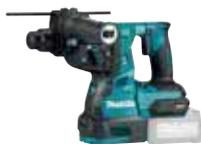
Leistungsstarker 40 V max. Akku-Kombihammer mit SDS-PLUS-Werkzeugaufnahme. Für staubfreies Arbeiten kann die optionale Staubabsaugung DX12 aufgesetzt werden. Die Maschine verfügt über einen Drehstopp, damit auch leichte Meißelarbeiten möglich sind. Mit AVT zur Reduzierung von Vibrationen.
