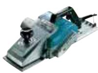
Ein starker 1.200 W Zimmermannshobel für härteste Beanspruchung. Eine lange Hobelsohle von 529 mm ermöglicht exaktes Arbeiten und eine sichere Führung. Spanabnahme von 0 bis 2 mm stufenlos einstellbar, Hobelbreite 170 mm. Geräuscharmer Betrieb und einfache Einstellung der Spanabnahme mit einem Einstellknopf.
