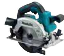
**AWS** Akku-Handkreissäge mit einer sehr kompakten und kurzen Bauform. Sie ist für Sägeblätter mit 165 mm Durchmesser ausgelegt und erreicht eine max. Schnitttiefe von 57 mm. Die integrierte Blasvorrichtung hält die Schnittstelle sauber, eine leuchtstarke Doppel-LED leuchtet das Werkstück zusätzlich aus. Mit AWS-Technologie zum automatischen Einschalten der Staubabsaugung.
