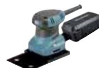
Ein geräuscharmer und kompakter vibrationsarmer Schwingschleifer für eine Vielzahl an Schleifanwendungen. Konzipiert für das Schleifen von Ecken oder engen Stellen mit verlängertem dreieckigem Sockel. Das Gerät hat einen leistungsfähigen 200 W Motor und eine Schleifplattengröße von 100 x 164 mm. Motordrehzahl: 14.000 min<sup>-1</sup>.
