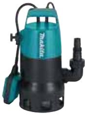
Eine kompakte elektrische Klar- und Schmutzwasserpumpe mit einer Fördermenge bis 8.400 l/h. Partikelgrößen bis 35 mm sind für die Pumpe kein Problem. Mindestwasserstand nur 40 mm. Mit automatischer Abschaltung durch einstellbaren Schwimmschalter. Für Eintauchtiefen bis 5 m.
