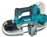
Mit bürstenlosem Motor für geringen Stromverbrauch und dadurch längerer Akku-Standzeit. Mit Konstantelektronik und Motorbremse. Die Bandgeschwindigkeit ist elektronisch regelbar. Durch die stabile Brückenkonstruktion mit einem Aluminium-Rahmen ist die Maschine sehr robust. Die Lieferung erfolgt ohne Ladegerät, ohne Akku im Karton.
