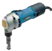
Ein schlanker Knabber, der sauber-kantige gerade und kurvenförmige Schnitte erreicht. Ideal für das Schneiden von z. B. Dachbaustoffen. Die Knabbermatrize ist um 360 Grad verstellbar mit 90 Grad Arretierung. Eine Schnittleistung von 2,5 mm für Aluminium und 1,6 mm für Stahl. Motorleistung 550 W, Leerlaufhubzahl 2.200 min<sup>-1</sup>. Kommt in einem MAKPAC.
