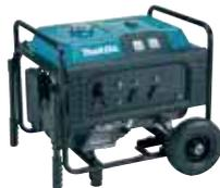
Zuverlässiger und langlebiger Generator mit Hochleistungs-OVH-Motor für max. 2.800 W Elektrowerkzeuge. Der Generator ist mit einem Strom- und Spannungsmessgerät ausgestattet und einfach zu starten. Durch einen Ölstandssensor schaltet das Gerät bei zu niedrigem Ölspiegel automatisch ab. Der Generator hat einen Kraftstofftank mit 25 l Fassungsvermögen.
