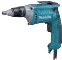
Schnellbauschrauber mit einem präzise einstellbarem Tiefenanschlag für ein schnelles und genaues Arbeiten bei einer Drehzahl von 0 - 6.000 min<sup>-1</sup>. Speziell geeignet für das Verarbeiten von Gipskartonplatten auf Metallständerwerk. Ein ergonomisches Design und gummierter Handgriff sorgen für gute Handhabung. Elektronisch regelbare Drehzahl mittels Schalter. Der Schraubendreher hat ein LED-Arbeitslicht.
