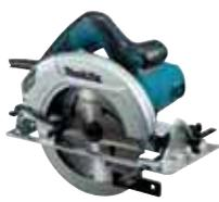
Eine robuste Handkreissäge mit 1.200 W Motor und einer Drehzahl von 5.200 min<sup>-1</sup>, konzipiert für den professionellen Einsatz. Für Sägeblätter mit 190 mm Durchmesser erreicht die Maschine eine Schnitttiefe von max. 66 mm. Kompaktes Design für zusätzliche Kontrolle und Sicherheit. Führungsschiene und Adapter als Zubehör.
