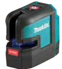
Selbstnivellierender Kreuzlinienlaser mit roten vertikalen und horizontalen Linien, die getrennt oder zusammen verwendet werden können. Sichtweite 25 Meter. 2 Helligkeitsstufen. Der Laser ist staub- und spritzwassergeschützt mit IP54-Schutzklasse, seine Laufzeit mit einer 4,0 Ah-Akkuladung beträgt etwa 40 h.
