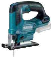
Leistungsfähige Säge mit dreistufiger PendelhubEinstellung und werkzeuglosem Sägeblattwechsel. Die Hubzahl kann zwischen 800 und 3.000 min<sup>-1</sup> mittels Einstellrad geregelt werden. Die Hubhöhe von 23 mm erlaubt eine Schnittleistung von 90 mm bei Holz sowie 10 mm bei Stahl.
