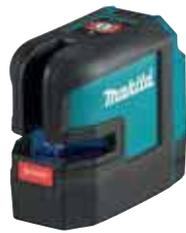
Selbstnivellierender Kreuzlinienlaser mit roten vertikalen und horizontalen Linien, die getrennt oder zusammen verwendet werden können. Punkt lasert auf, ab, links, rechts. Sichtweite 25 Meter. 2 Helligkeitsstufen. Der Laser ist staub- und spritzwassergeschützt mit IP54-Schutzklasse, seine Laufzeit mit einer 4,0 Ah-Akkuladung beträgt etwa 40 h.
