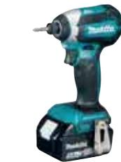
Ein kompakter und leichter bürstenloser Schlagschrauber mit 18 V Antrieb und einem Antriebsschaft 1/4". Ein kleines und leichtes Gerät, das leicht bedienbar ist und dennoch ein max. Anzugsdrehmoment von 170 Nm bietet, geeignet für schnelles Schrauben. Ein handliches LED-Arbeitslicht für zusätzliche Beleuchtung.
