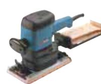
Ein äußerst leistungsfähiger vibrationsarmer Schwingschleifer für eine Vielzahl an professionellen Schleifanwendungen. Große Orbitalbewegung für effektives Schleifen. Das Gerät hat einen starken 600 W Motor und eine 115 x 229 mm große Schleifplatte. Motordrehzahl 6.000 min<sup>-1</sup>.
