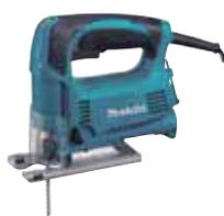
Eine leistungsfähige und leichte 450 W Pendelhubstichsäge mit dreistufiger PendelhubEinstellung + Neutralstellung. Wirkungsvolles Antivibrationssystem und niedriger Geräuschpegel. Motordrehzahl kann zwischen 500 und 3.100 min<sup>-1</sup> eingestellt werden. Hubhöhe 18 mm. Schnittleistung Holz 65 mm, Stahl 6 mm. Aluminium-Schwenkboden.
