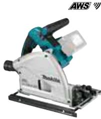
**AWS** Eine präzise Tauchkreissäge mit einem bürstenlosen Motor. Zwei 18 V Akkus erzeugen eine Stromspannung von 36 V. Die Säge ist für Sägeblätter mit 165 mm Durchmesser ausgelegt und erreicht eine max. Schnitttiefe von 56 mm. Eine Führungsschiene ist optional verwendbar. Mit AWS-Technologie zum automatischen Einschalten der Staubabsaugung. Inklusive AWS Funkadapter WUT01.
