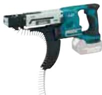
Akku-Magazinschrauber mit 18 V Antrieb für gegurtete Schrauben. Die lange Schraubenführung verhindert das Verkanten des Gurtes. Der Akku-Magazinschrauber ist für 25 bis 55 mm Schrauben geeignet.
