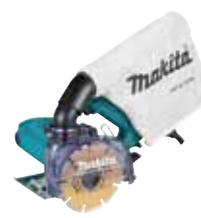
Ein kompakter und leichter 1.400 W Diamantschneider mit hoher Drehzahl. Ideal für staubfreies Aufschneiden von Mörtelfugen und Schneiden von Fliesen, Steinen und ähnlichem. Maximale Schnitttiefe von 40 mm mit einer Diamantscheibe von 125 mm Ø.
