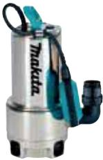
Eine robuste elektrische Klar- und Schmutzwasserpumpe mit rostfreiem Edelstahlgehäuse. Für eine Fördermenge bis 15.000 l/h. Partikelgrößen bis 35 mm sind für die Pumpe kein Problem. Mindestwasserstand 50 mm. Mit automatischer Abschaltung durch einstellbaren Schwimmschalter. Für Eintauchtiefen bis 5 m.
