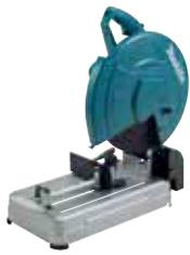
Eine 2.200 W Trennschleifmaschine für präzises Schneiden von Metall. Mit Tragegriff für einfachen Transport und guter Funkenflugführung. Mit Schnellspannvorrichtung und einstellbarer Schnittleistung. Schneidet bis zu 194 mm mit einem Sägeblattdurchmesser von 355 mm. Werkzeuglos verstellbarer Schraubstock für Gehrungsschnitte bis 45°.
