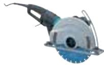
Eine benutzerfreundliche, sichere Steinsäge. Eine 305 mm Diamantscheibe ermöglicht eine maximale Schnitttiefe von 100 mm. Soft-Start Funktion für zusätzliche Sicherheit. Nur für den Trockenschnitt geeignet.
