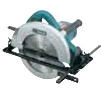
Eine robuste und hochleistungsfähige Handkreissäge mit einem 2.000 W Motor und einer Drehzahl von 4.100 min<sup>-1</sup>, konzipiert für professionelle Anwendungen. Mit einem Sägeblattdurchmesser von 235 mm erreicht die Säge eine Schnitttiefe von max. 85 mm, bei 50° Schrägschnitt 53 mm. Die geräuscharme Säge verfügt über leichte und robuste Magnesiumbauteile.
