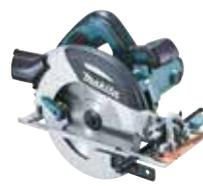
Eine robuste Handkreissäge mit Motorbremse, 1.400 W Motor und einer Drehzahl von 5.500 min<sup>-1</sup>, konzipiert für den professionellen Einsatz. Für Sägeblätter mit 190 mm Durchmesser erreicht die Maschine eine Schnitttiefe von max. 67 mm. Kompaktes Design für zusätzliche Kontrolle und Sicherheit. Führungsschiene und Adapter als Zubehör.
