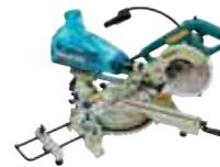
Eine Kapp- und Gehrungssäge mit einem 1.010 W starken Motor und hoher Schnittleistung von 52 x 300 mm. Max. Sägeblattdurchmesser 190 mm. Eine ideale Wahl für den Baubereich und andere anspruchsvolle Branchen. Ein doppelter Zug-Mechanismus erhöht die Schnittleistung bei kompakter Bauweise.
