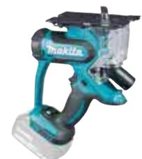
Ein benutzerfreundliches Gerät zum Schneiden von Öffnungen in Trockenbaustoffen für das Anbringen von Leuchtmitteln oder Klimakanälen. Dies ist ein handliches Gerät für Bau- und Renovierungsvorhaben. Einstellbare Schnittleistung von 1 bis zu 15 mm. Inklusive einer leistungsfähigen Staubabsaugung, insbesondere in Verbindung mit einem Staubsauger.
