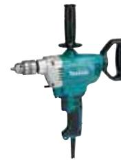
Eine robuste Bohrmaschine mit niedriger Drehzahl zum Einsatz als Rührgerät. Mit Kreuzgriff und drehbarem Spatengriff zum Schutz des Bedieners. Geeignet für große Bohrdurchmesser und zum Mischen. Mit Zahnkranzbohrfutter mit einer Spannweite von 2 - 13 mm.
