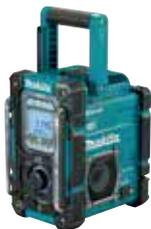
Baustellenradio für den Empfang von DAB/DAB+ und AM/FM sowie Bluetooth®-Funktion. Mit Ladefunktion für Makita Lithium-Ionen-Schiebeakkus 12 V max. (10,8 V), 14,4 V und 18 V. Ladezeit bei 18 V 5,0 Ah: 80 Minuten. Schutzklasse IP64 für Spritzwasser.
