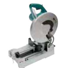
Kaltkreissäge mit kraftvollem 1.750 W Motor und einer Schnitttiefe von max. 115 mm. Für schnelles und fast funkenfreies Schneiden von Metall. Werkzeuglos verstellbarer Schraubstock für Gehrungsschnitte bis 45°. Mit Schnellspannvorrichtung.
