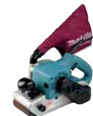
Ein starker Bandschleifer mit hoher Abtragleistung dank eines 1.200 W starkem Motor. Die Kugellager sind durch Labyrinthabdichtungen besonders effektiv gegen Staub geschützt. Kompatibel mit einem 100 mm breiten Band, erreicht die Maschine eine Bandgeschwindigkeit von 500 m/min. Effiziente Staubabsaugung mit 360° drehbarem Staubsaack.
