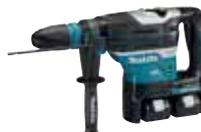
Leistungsstarker Akku-Kombihämmer mit SDS-Max Aufnahme und einer Ausrastkupplung. Der 2 x 18 V Antrieb sorgt für besonders kraftvolles Hammerbohren und Meißeln. Durch die AWS Funktion startet die Staubabsaugung automatisch beim Anlaufen. Die Einzelschlagstärke erreicht bis zu 8,0 Joule, in Beton beträgt die Bohrleistung bis zu 40 mm. Inklusive AWS Funkadapter WUT01.
