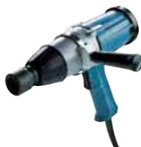
Ein starker Schlagschrauber mit 3/4" Aufnahme. Der 850 W Motor erzielt ein max. Drehmoment von 588 Nm. Ideal für Anwendungen, die ein sehr hohes Anzugsdrehmoment erfordern. Wippschalter zum schnellen Wechsel zwischen Rechts- und Linkslauf sowie Seitengriff für zusätzlichen Komfort.
