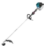
Eine Motorsense mit vibrationsarmen, gummiertem Soft-Griff. Die Abgasemissionen sind dank des 4-Takt-Motors geringer gegenüber einem 2-Takt. Hubraum 25,4 cm³, Motorleistung 0,77 kW / 1,1 PS. Die Schutzhaube ist sowohl für Metallmesser, als auch Nylon-Fadenkopf geeignet. Läuft lageunabhängig dank optimalem Motorschmiersystem.
