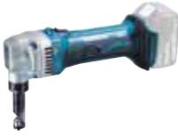
Der Akku-Knabber mit schlanker Bauform eignet sich ideal zum Trennen von Blechtafeln, Well- und Trapezblechen. Die Knabbermatrize ist um 360° stufenlos verstellbar. Gerade und Kurvenschnitte lassen sich präzise ausführen. Die Schnittleistung beträgt 2,5 mm für Aluminium und 1,6 mm für Stahl.
