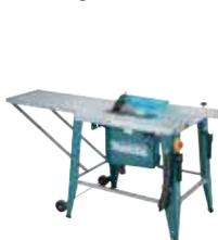
Eine präzise Tischkreissäge mit einem 2.000 W Motor und einer Drehzahl von 3.400 min<sup>-1</sup> für den täglichen Baustelleneinsatz. Max. Schnittleistung: 85 mm bei einem 90°-Winkel und 58 mm bei einem 45°-Winkel. Der Tisch ist mit einer Tischverlängerung ausgestattet und verfügt über Räder und Handgriffe zum leichten Transport.
