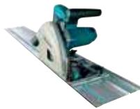
Eine präzise Tauchkreissäge für genaues Schneiden. Ideal für die Installation von Ausrüstung oder Verlegung von Bohlenbelag. Empfohlen für den Einsatz mit einer Führungsschiene. Eine Motorleistung von 1.300 W, Schnittleistung 56 mm. Drehzahl kann zwischen 2.000 und 6.400 min<sup>-1</sup> eingestellt werden. Führungsschiene inklusive.
