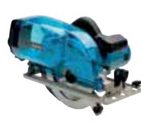
Eine effiziente Handkreissäge mit Staubbox und einem 1.400 W Motor. Drehzahl 4.800 min<sup>-1</sup>. Konzipiert für professionelle Anwendungen. Mit einem Sägeblattdurchmesser von 190 mm erreicht die Säge eine Schnitttiefe von 66 mm. Die Staubbox macht das Anschließen einer Fremddabsaugung in den meisten Fällen überflüssig. Ideal für Innenausbau und Montage.
