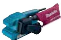
Ein leicht bedienbarer Bandschleifer mit einem 650 W Motor. Die Bandgeschwindigkeit kann zwischen 75 und 270 m/min eingestellt werden. Die Oberseitenkonstruktion erlaubt es dem Schleifer, auch als Tischwerkzeug eingesetzt zu werden. Geeignet für 76 mm breite Schleifbänder.
