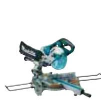
Eine leichte und präzise Akku-Kapp- und Gehrungssäge für Zuschnittarbeiten bei Renovierungs- und Bauvorhaben. Die Schnittleistung beträgt 52x300 mm, Kapp- und Gehrungsschnitte sind nach links und rechts möglich. Mit Dual-Slide-System zum Sägen großer Werkstücke. Der bürstenlose Motor sorgt für einen effektiven Umgang mit der Akku-Energie.
