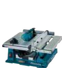
Eine präzise Tischkreissäge mit einem 1.650 W Motor und einer Drehzahl von 4.800 min<sup>-1</sup> für den täglichen Baustelleneinsatz. Max. Schnittleistung: 93 mm bei einem 90°-Winkel und 64 mm bei einem 45°-Winkel.
