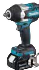
Ein kraftvoller 18 V Akku-Schlagschrauber mit einem Anziehdrehmoment bis 700 Nm für die industrielle Fertigung und Bauanwendungen. 1/2"-Außenvierkantaufnahme mit Kugelrastung. Mit Auto-Stopp-Funktion zur effizienten Energienutzung. Eine Doppel-LED hilft bei schwierigen Lichtverhältnissen. Die Lieferung erfolgt mit Ladegerät und 2 Akkus BL1850B.
