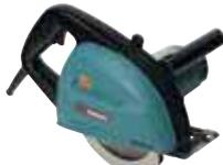
Ein 1.100 W Metallschneider mit einer Schnitttiefe von max. 63 mm. Ein funkenfreier Metallschneider für grat- und verbrennungsfreies Schneiden. Effizientes Einsammeln von Metallspänen in einem integrierten Behälter. Schnittkapazität Weichstahl: max. 6 mm.
