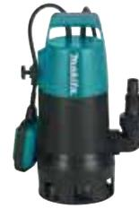
Eine kompakte elektrische Klar- und Schmutzwasserpumpe mit einer Fördermenge bis 14.400 l/h. Partikelgrößen bis 35 mm sind für die Pumpe kein Problem. Mindestwasserstand nur 40 mm. Mit automatischer Abschaltung durch einstellbaren Schwimmschalter. Für Eintauchtiefen bis 5 m.
