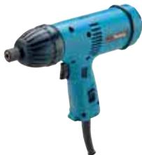
Schlagschrauber mit 1/4"-Innensechskantaufnahme mit einem 360 W Motor und max. Drehmoment von 196 Nm. Kompaktbauweise, zudem leicht und gut ausbalanciert. Zwei verschiedene Anziehdrehmomente einstellbar.
