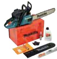
Die Kettensäge hat dank ihres modernen 2-Takt Motors niedrige Verbrauchs- und Emissionswerte. Sie hat eine 45 cm Sägeschiene und einen 3,0 kW / 4,1 PS Motor, der eine Kettengeschwindigkeit von 19,3 m/s erzielt. Ausgestattet mit einer Leichtstartfunktion.
