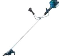
Die Sense hat einen Hubraum von 25,7 cm³ und eine Leistung von 0,83 kW, das entspricht ca. 1,2 PS. Der Motor ist mittels Federunterstützung leicht zu Starten. Der Zweihandgriff dient der sicheren Führung der Sense und reduziert Ermüdungserscheinungen an Unterarm und Hand. Durch einen Katalysator werden strenge Abgasnormen eingehalten.
