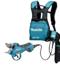
Leistungsstarke 2 x 18 V Akku-Astschere mit 250 N für Zweige bis zu einem Durchmesser von 33 mm. Geeignet für Präzisionsarbeit bspw. im Wein- und Obstbau. Die Akkus befinden sich während des Betriebs in einem mitgelieferten Rucksack, nur die Schere muss gehalten werden.
