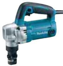
Ein schlanker Knabber, der sauber-kantige gerade und kurvenförmige Schnitte erreicht. Mit Bügelhandgriff. Ideal für das Schneiden von z. B. Dachbaustoffen. Eine Schnittleistung von 3,5 mm für Aluminium und 3,2 mm für Stahl. Motorleistung 710 W, Leerlaufhubzahl 1.300 min<sup>-1</sup>. Kommt in einem MAKPAC.
