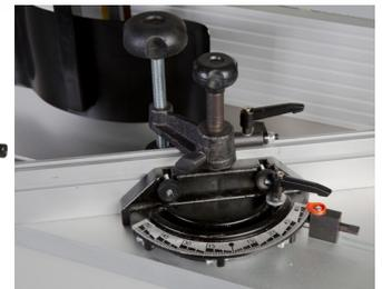
Stufenlos verstellbarer Winkelanschlag
