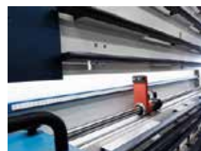
Schwerer Längsanschlag mit Feineinstellung, beleuchteter Skala
