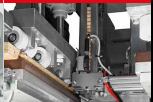
Bohren – Leimen – Dübeln
