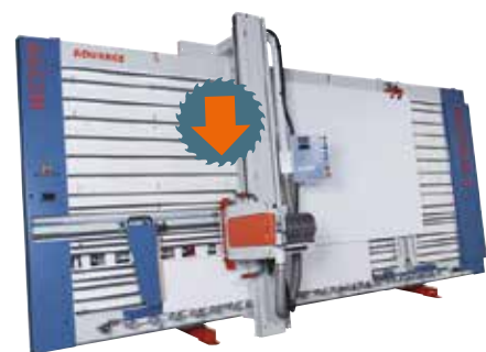
Extrem stabile Rollenauflage mit pneumatischer Klemmvorrichtung
