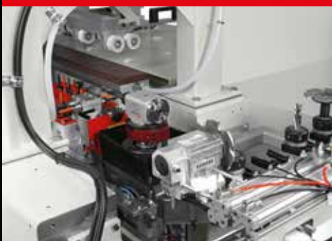
Bohr- & Fräsaggregat und 6-fach Wechsler
