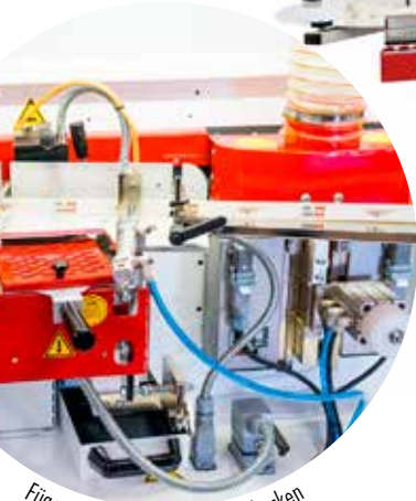
Fügeaggregat / EVA/PUR Leimbecken
