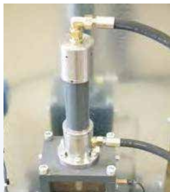
Endlagergedämpfter Füllzylinder und staubdichter Füllschacht
