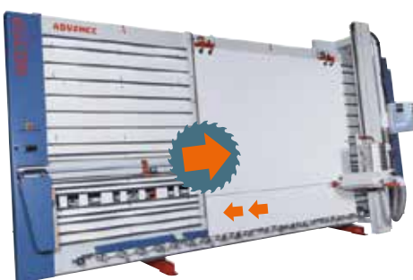
ELCON Vorritz- und Nutsystem mit Sägeblatttiefebeneinstellung
