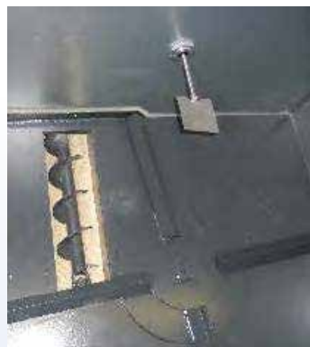
Rührwerk, Förderschneckenverdichter und Füllstandsmelder im Inneren
