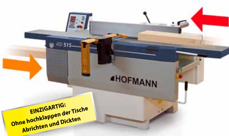
beide Abrichttische werden gemeinsam aufgeklappt – Schutzhaube aufsetzen – fertig
